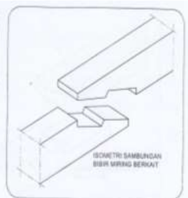
Gambar 7.9 Isometri sambungan bibir miring berkait
